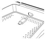
Stecken Sie das USB-Typ-A-Ende des Ladekabels in die Riickseite von DryBoost UV.
