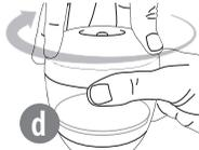
Bringen Sie den Deckel wieder an der Trocknungseinheit an, indem Sie die Laschen am Deckel mit den Kerben an der Einheit ausrichten. Zum Schließen im Uhrzeigersinn drehen.
