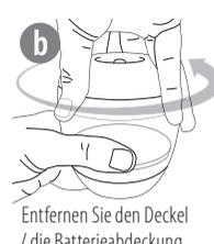
Entfernen Sie den Deckel / die Batterieabdeckung, indem Sie ihn gegen den Uhrzeigersinn drehen.
