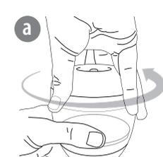
Entfernen Sie den Deckel und die Batterieabdeckung, indem Sie sie gegen den Uhrzeigersinn drehen.
