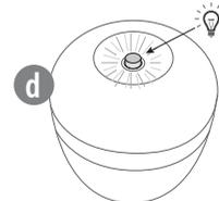
Das Licht pulsiert langsam für ungefähr 3-1/2 Minuten dann automatisch abschalten. Die UV-C-Funktion ist abgeschlossen.
