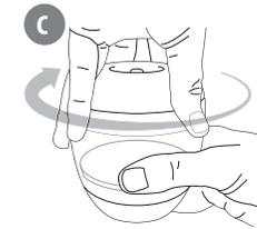
Bringen Sie den Deckel wieder an der Trocknungseinheit an, indem Sie die Laschen am Deckel mit den Kerben an der Einheit ausrichten. Zum Schließen im Uhrzeigersinn drehen.
