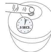
Während sich die UV-C-Lampe in 3-1/2 Minuten automatisch ausschaltet, möchten Sie den Zyklus möglicherweise stoppen, bevor er abgeschlossen ist. Halten Sie dazu einfach die LED-Betriebsanzeige 5 Sekunden lang gedrückt. Das rote Licht erlischt und zeigt an, dass der Zyklus gestoppt wurde.
