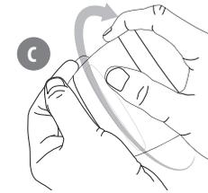
Befestigen Sie die Basis wieder an der Trocknungseinheit, indem Sie die Laschen an der Basis mit den Kerben an der Einheit ausrichten. Zum Schließen im Uhrzeigersinn drehen.
