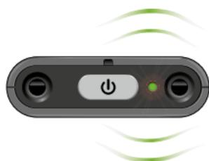
Akku ist mit einer Stromquelle verbunden und wird aufgeladen
