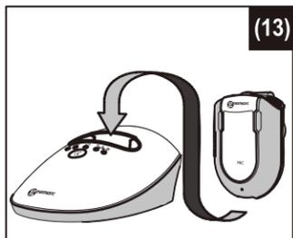
Werden die Kopfhörer nicht benutzt, bringen Sie den Schalter in die Aus-Position, um eine Beschädigung der Akkus zu vermeiden. Der Akku muss vor der ersten Inbetriebnahme stets voll geladen sein. Eine anfängliche Ladedauer von 3 Stunden ist erforderlich, um eine angemessene Nutzungsdauer des wiederaufladbaren Akkus zu gewährleisten. Stellen Sie stets sicher, dass der Empfänger während des Ladens des Akkus auf AUS geschaltet ist.
