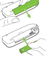
Verschließen Sie das Batteriefach, indem Sie den Deckel wieder zurückschieben.
